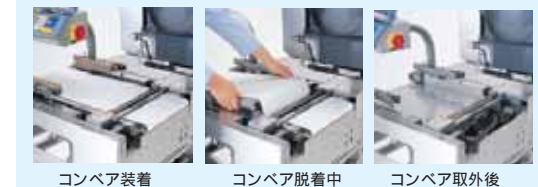
コンベア装着 コンベア脱着中 コンベア取外後
